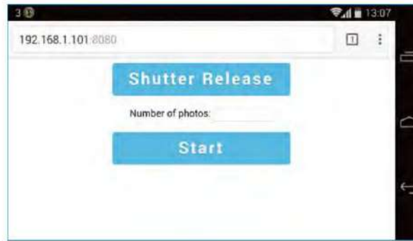
الشكل: تطبيق الويب الأساسي لجهاز التحكم عن بعد بالأشعة تحت الحمراء المستند إلى Raspberry Pi.
